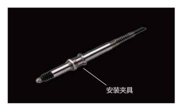
LVDT笔式位移传感器的定位安装要求采用温度膨胀系数小的非导磁夹具进行固定,如果采用金属铁块夹具安装会对产品性能产生影响。
